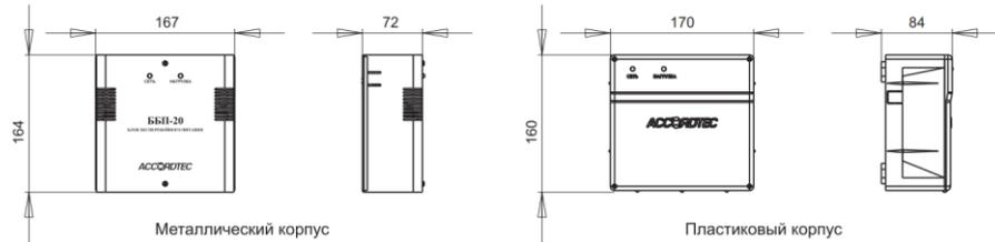
Блок питания обеспечивает зарядку аккумуляторной батареи емкостью 7А\*ч (не входит в комплект поставки), устанавливаемой потребителем в корпус источника током до 1 А и поддерживает ее в заряженном состоянии при наличии сетевого напряжения от (~) 110В до 250В.
